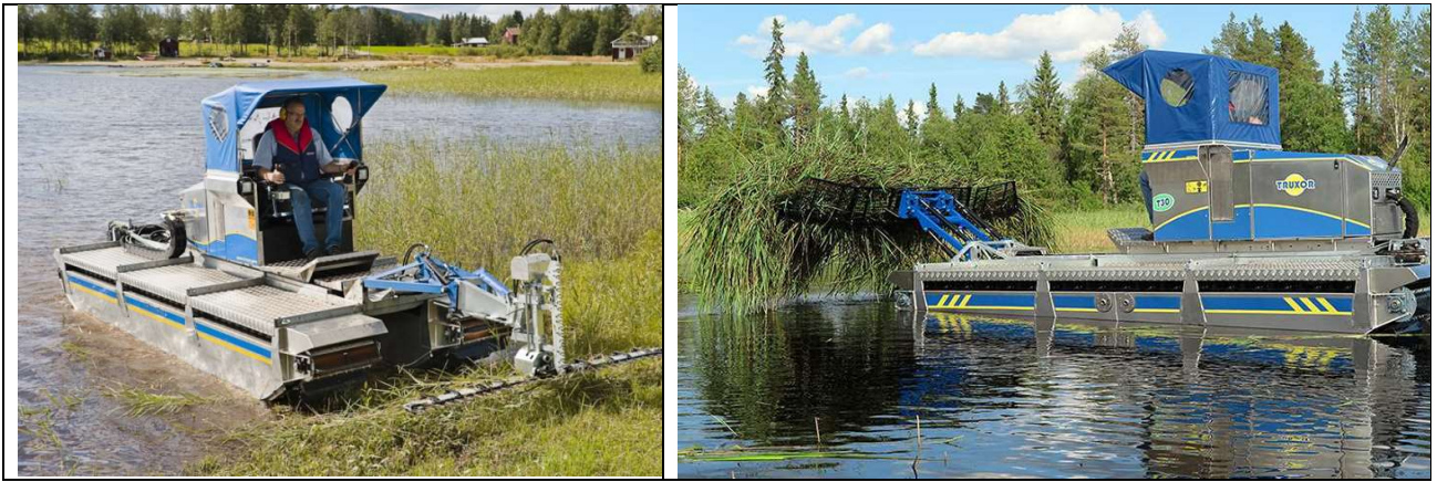
2.1.2.Pav. Helofitų šalinimas ir transportavimas amfibija Truxor
