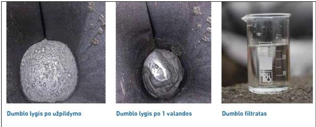
2.1.10.Pav. Dumblo filtravimas geotekstilės konteineryje (maiše) Šaltinis: UAB „Ekotakas“ medžiaga
