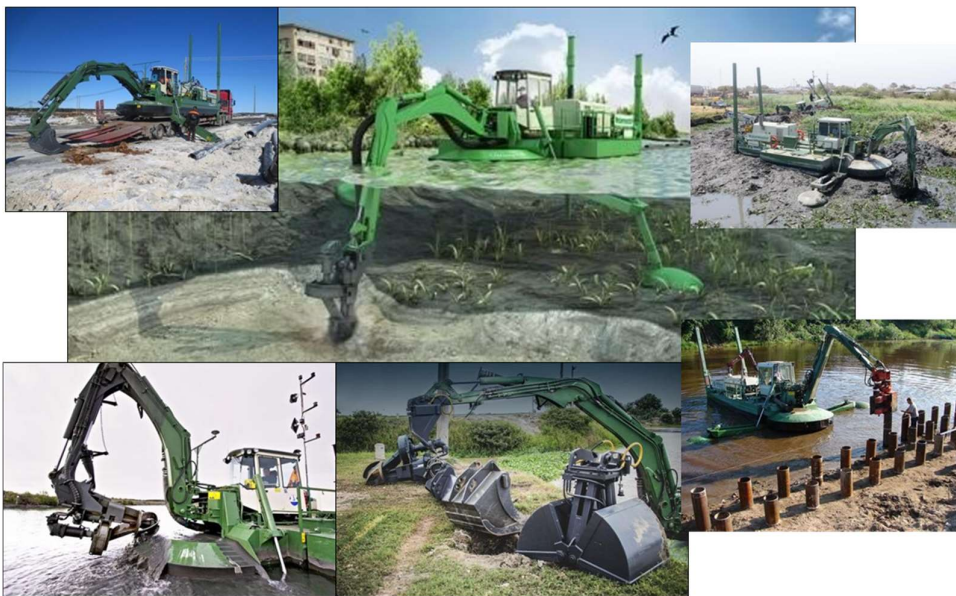
2.1.7.Pav. Universali žemsiurbė Watermaster Classic III (IV) Šaltinis: PŪV PAV atrankos medžiaga
